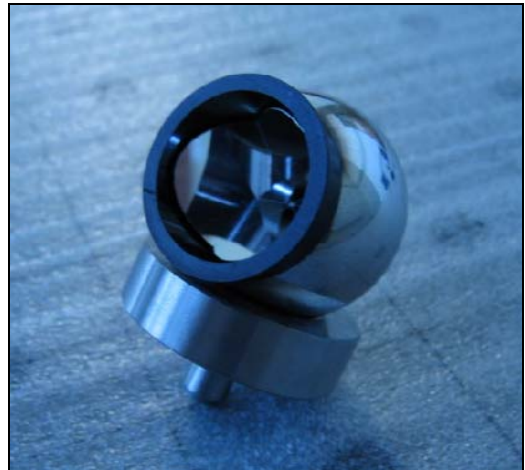
Abbildung 4 - Reflektor auf Pin Nest zur Adaption auf Referenzpunkt
