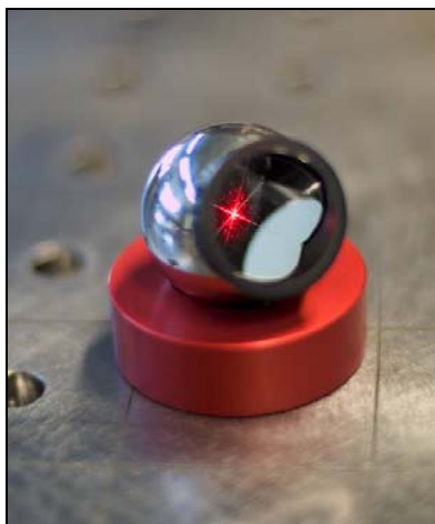
Abbildung 6 - Reflektor im Magnetnest
